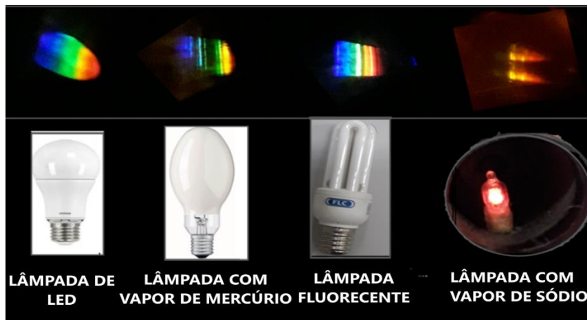
Figura 33: Lâmpadas e seus respectivos espectros.
